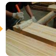
手作業による「米のり」の塗布
